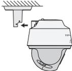
(3) 在下图位置**两侧都**打入自攻螺钉，将摄像机与支架固定。
