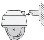
(3) 在下图位置**两侧都**打入自攻螺钉，将摄像机与支架固定。
